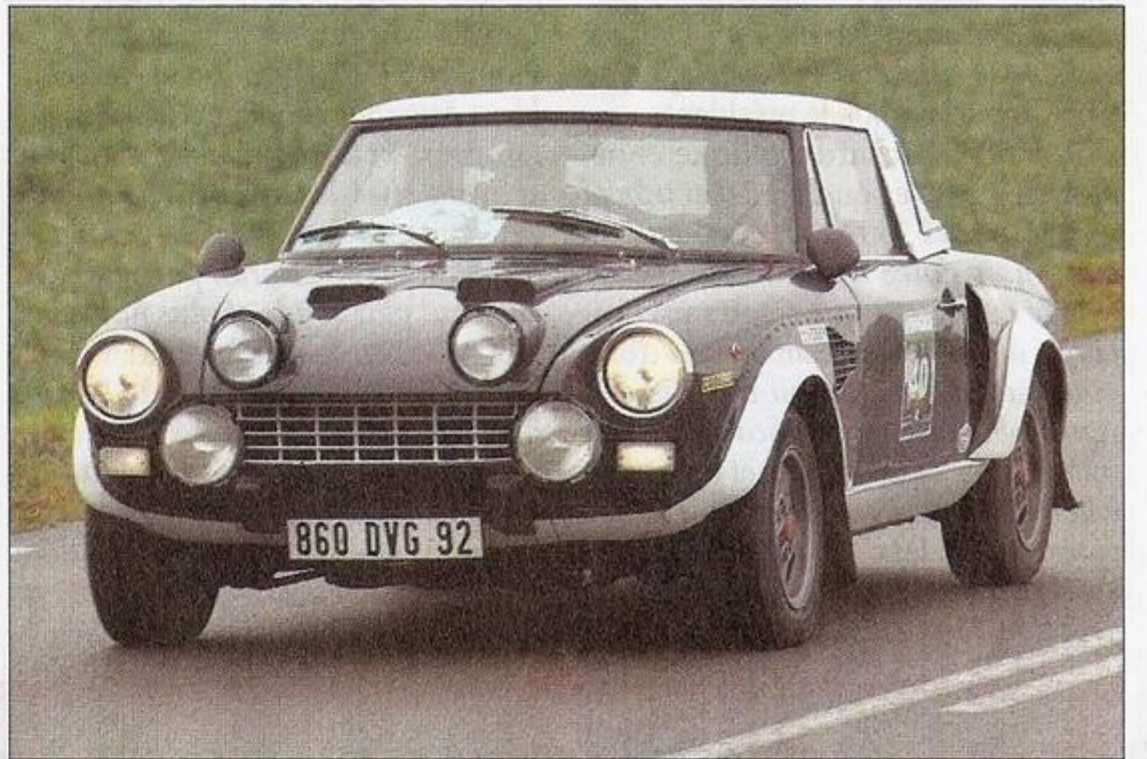
▲ Thierry Fusade et sa Fiat 124 Abarth, une compé-client qui a couru en Italie en 1975. Cette version Gr. 4 (moteur 1 800 de 160 ch) possède des freins avant spéciaux, des barres de torsion sur des rotules Uniball et un pont autobloquant.
