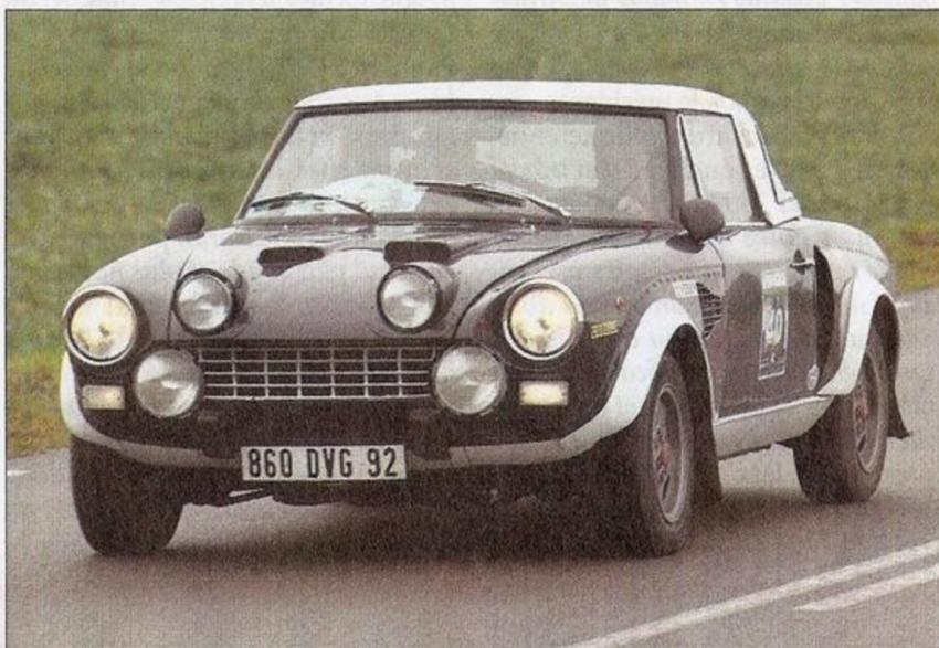
▲ Thierry Fusade et sa Fiat 124 Abarth, une compé-client qui a couru en Italie en 1975. Cette version Gr. 4 (moteur 1 800 de 160 ch) possède des freins avant spéciaux, des barres de torsion sur des rotules Unibal et un pont autobloquant.
